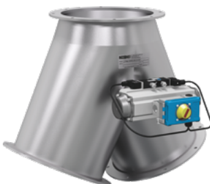
Beispiel: Klappkasten mit Kragen 50°, symmetrisch, Bauform DN > 300 mm mit angeschweißten Flanschen, pneumatisch betätigt mit Drehantrieb
