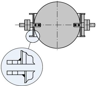
Sonderausführung: Absperrklappe ab DN 400 mm mit eingeklebter Dichtung aus Silikon
