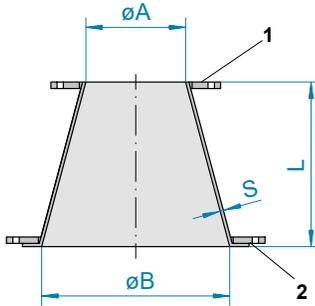
1 mit angeschweißtem Flansch ähnlich DIN 24154-2 (Abmessungen siehe S. 219)
