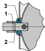
Querschnitt Absperrklappe mit Dichtung, Klappe geöffnet
