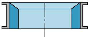
Durch die JACOB Modularität können Sie verschlissene Rohrteile einfach durch ausgekleidete Rohrteile der DURABLE DESIGN-Linie ersetzen. Dabei können Sie weiterhin Spannringe und Dichtungen aus dem Standardprogramm verwenden. Um einen optimalen Produktfluss zu gewährleisten, haben wir ein Einlaufstück (siehe Zeichnung) im Angebot, bei dem die Auskleidung angefasst und verstärkt befestigt wird. Es wird empfohlen, dieses Stück bei jedem Beginn einer ausgekleideten Rohrleitung einzubauen.
