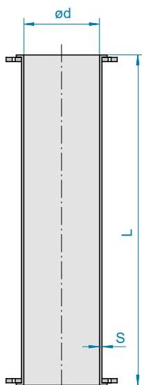
Die Rohrlänge und der Durchmesser DN sind Nennmaße, die wahre Länge ist unter L aufgeführt
