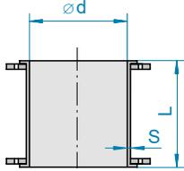
Die Rohrlänge und der Durchmesser DN sind Nennmaße, die wahre Länge ist unter L aufgeführt
