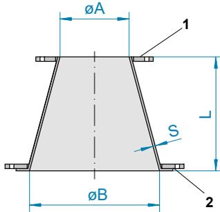
1 mit angeschweißtem Flansch aus Chromnickelstahl ähnlich DIN 24154-2 (Abmessungen siehe S. 219)
