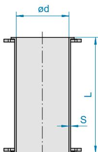
Die Rohrlänge und der Durchmesser DN sind Nennmaße, die wahre Länge ist unter L aufgeführt
