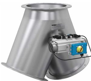
Beispiel: Klappkasten mit Kragen 50°, symmetrisch, Bauform DN > 300 mm mit angeschweißten Flanschen, pneumatisch betätigt mit Drehantrieb
