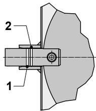
Querschnitt Absperrklappe ohne Dichtung, Klappe geöffnet
