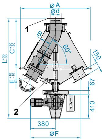
1 Ein- und Ausläufe mit angeschweißten Flanschen nach DIN 1092-1, PN 10
